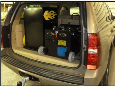
Hurtig demontering af materialekammer betyder, at maskinen kan transporteres i en almindelig bil. Rigtig praktisk til mindre isoleringsopgaver.
